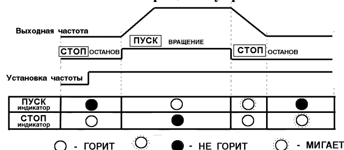
Рис. 11. Пояснения к пульту управления Изменение состояний световых индикаторов "ПУСК" и "СТОП" в процессе управления
